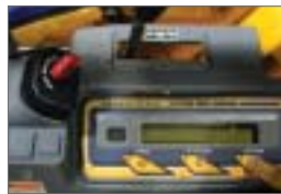
① 登録キー(赤)を挿入し、表示切替ボタンを押す。
