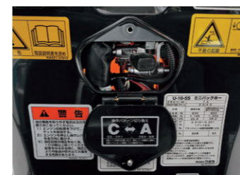
6 操作切り替え 工具不要でレバー動かすことで、2つの操作パターンに切り替えることが可能。
