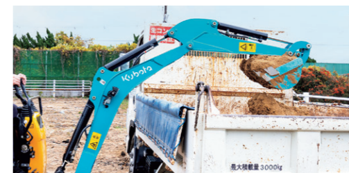
10 背面式ブームシリンダ 大きな石やコンクリート片等のバケットでのすくい込み、ダンプへの積み込みや搭載型ブレイカでの作業時もブームシリンダの損傷を気にせずに作業を行います。
