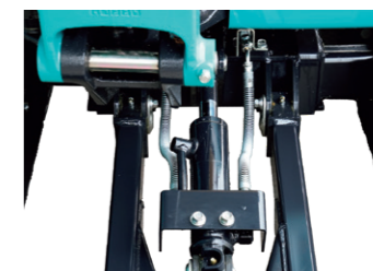
8 分割式ドーザーホース 不意の破損の場合もホース交換が容易に行えます。
