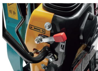
2 操作ロックレバー 操作ロックレバーが上がった状態でないとエンジンがかからない、エンジンニュートラルスタート機能を搭載しました。
