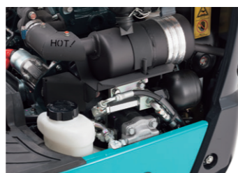
5 アク्यूムレータ装備 (ROPS仕様のみ) エンジンが急停止しても30秒間は作業機を降ろすことができるアク्यूムレータを装備。
