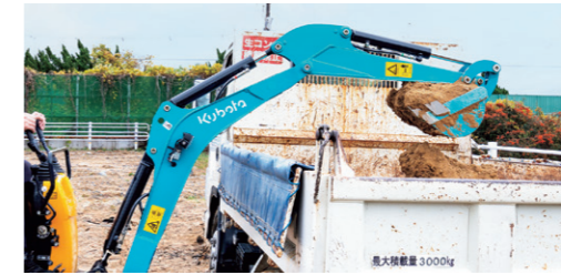
9 背面式ブームシリンダ 大きな石やコンクリート片等のバケットでのすくい込み、ダンプへの積込みや搭載型ブレーカでの作業時もブームシリンダの損傷を気にせずに作業を行います。
