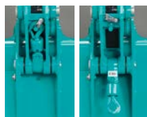
クレーン格納時 クレーン使用時
