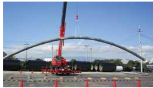
GX形呼び径300を11本繋いで吊上げた状態
