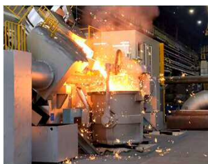
< 電気炉の稼働状況 >
