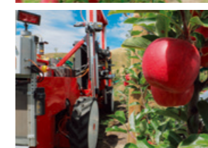
リンゴの自動収穫ロボット (Abundant Robotics社提供)
