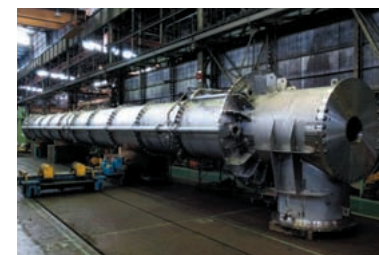
全長24mのクボタ最長クラスのポンプ
