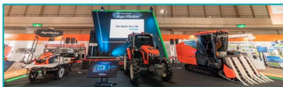
開発中の自動運転農機 ・アグリロボ田植機（8条植） ・アグリロボトラクタ（100馬力） ・アグリロボコンバイン（自脱型6条刈）
