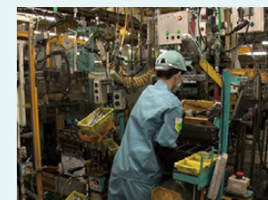
部品はすべて前方から供給され、作業ツールも40cm以内に配置。振り向かず、歩かず、手で組立が可能です。
