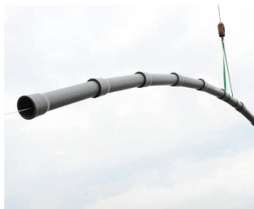
水道インフラを支える耐震型ダクタイル鉄管
