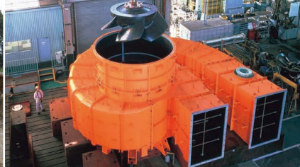
●ポンプ 上下水道や農林、雨水市場などで 水に圧力を与えるために使用されます。
