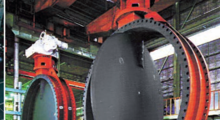
●バルブ 上下水道や農業用水などの水や気体を制御するために使用されます。
