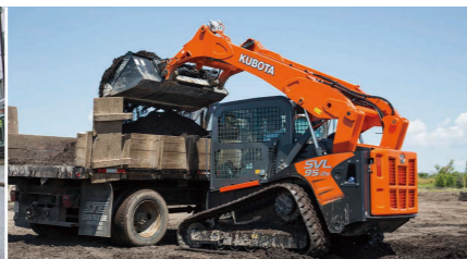
●コンパクトトラックローダ 主に建設現場や農場などで、運搬・積込作業を行います。
