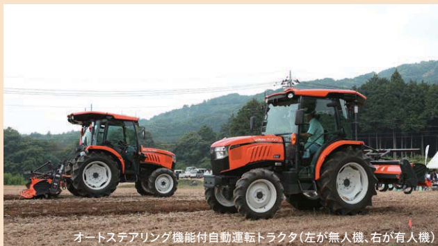
オートステアリング機能付自動運転トラクタ(左が無人機、右が有人機)
