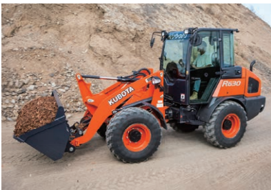
ホイールローダ 主に建設現場や農場などで、運搬・積込作業を行います。
