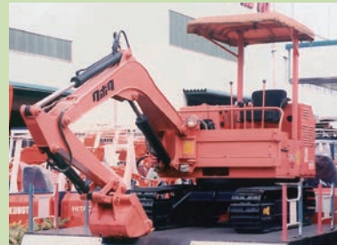
後のクボタミニバックホーのベースとなった 全旋回式小型油圧ショベル(KH1)
