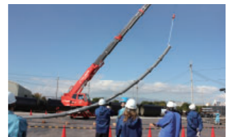
耐震性を確認する吊り下げ実験
