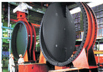
バルブ 上下水道や農業用水などの水や気体を制御するために使用されます。
