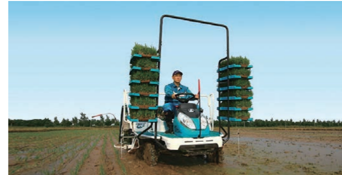
田植機 稲の苗を水田に移植します。省人・軽労化に大きく貢献します。
