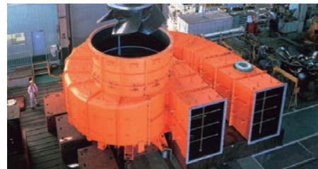
ポンプ 水道・下水道・雨水排水などで、水を圧送するために使用されます。
