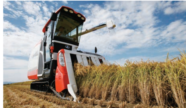
コンバイン コメや麦、豆類などを刈り取ると同時に脱穀します。
