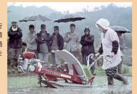
後の田植機の原型となった歩行型全自動田植機 (SPS形)
