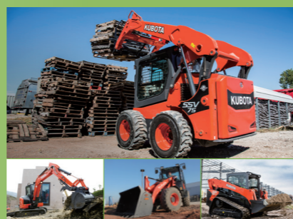
上:スキッドステアローダ 下:左からミニバックホー、ホイールローダ、コンパクトトラックローダ
