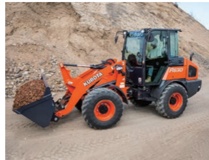
ホイールローダ 主に建設現場や農場などで、運搬・積込作業を行います。
