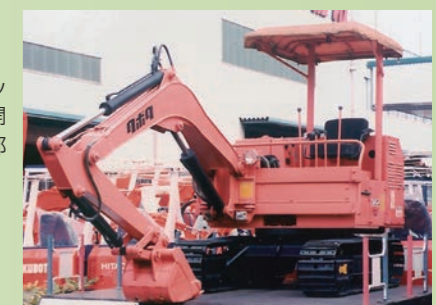
後のクボタミニバックホーのベースとなった全旋回式小型油圧ショベル(KH1)
