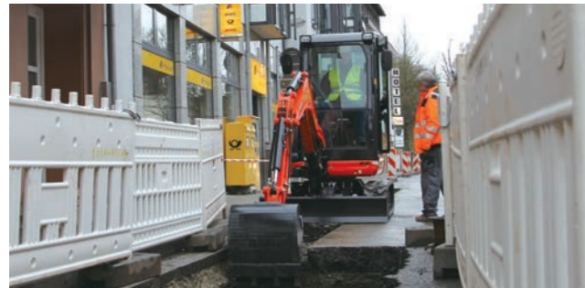
ミニバックホー 土木作業などを行います。市街地など狭い現場を得意とします。
