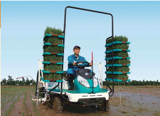
田植機 稲の苗を水田に移植します。省人・軽労化に大きく貢献します。
