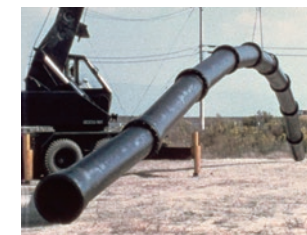
耐震継手ダクタイル鉄管の吊り上げテスト
