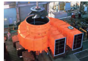
19 ポンプ 水道・下水道・雨水排水などで、水を圧送するために使用されます。
