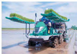
3 田植機 稲の苗を水田に移植します。省人・軽労化に大きく貢献します。
