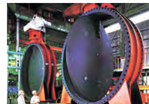
18 バルブ 水道・下水道などで、液体・気体を制御するために使用されます。
