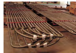
24 鋳鋼 エチレン精製など石油化学プラントで使用されます。
