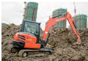
9 ミニバックホー 土木作業などを行います。市街地など狭い現場を得意とします。
