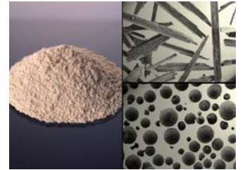
24 ティーザクス 主にプレーキパッドなどの摩擦材の素材に使用されます。
