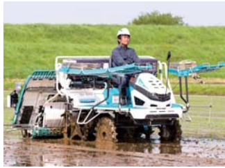
2 田植機 稲の苗を水田に移植します。省人・軽労化に大きく貢献します。
