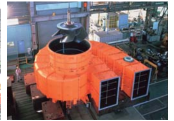
12 ポンプ 水を圧送し、水道・下水道、雨水排水などに使用されます。
