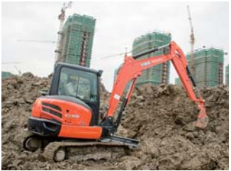
7 建設機械(ミニバックホー) 土木作業などを行います。市街地など狭い現場を得意とします。
