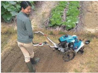
4 ミニ耕うん機 小規模な農地で耕うんなどの農作業を行います。
