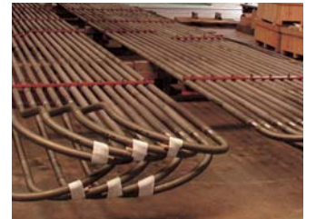
20 鋳鋼 エチレン精製など石油化学プラントで使用されます。
