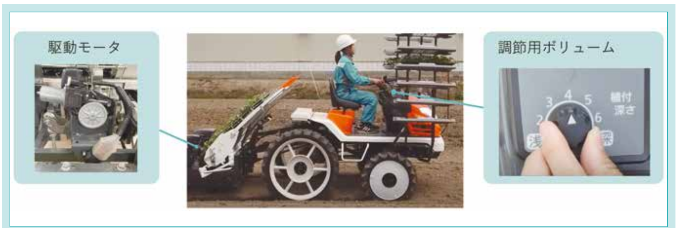
図 13 植付け深さ調節構造 Fig. 13 Planting Depth Adjustment Structure
