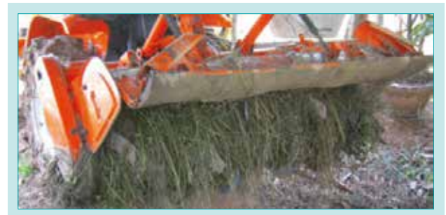
Fig. 9 Picked-up Stalks Jamming into Rotary Machine 図 9 ローターに巻き付いた刈取り後の茎
