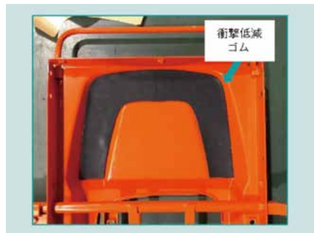
図 15 衝撃低減ゴム Fig. 15 Frame Protect Rubber
