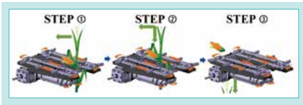
Fig. 6 CH70 Unit Harvester for Corn Pod Separating Process 図 6 CH70 刈取りユニットでの房分離プロセス
