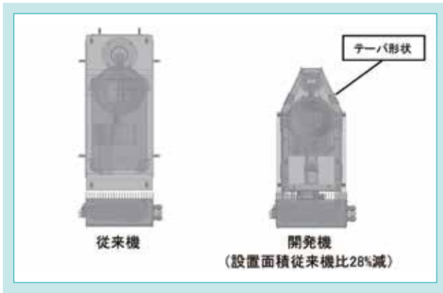
図5 設置面積 Fig. 5 Installation Area
