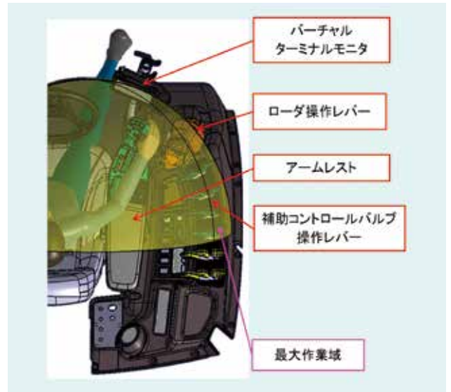
図 8 コントロールレバー配置と最大作業エリア Fig. 8 Control Lever Layout and Maximum Work Area
