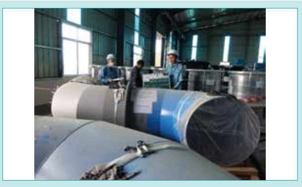
図5 ポンプ廻りの鋼管の受入検査 Fig. 5 Acceptance Inspection (Steel Pipe)
