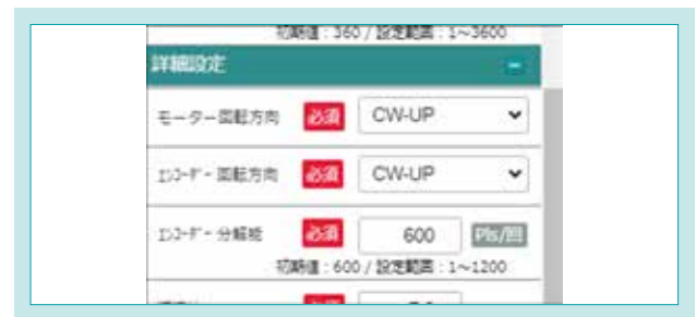
図4 制御設定変更画面(一部抜粋) Fig. 4 Control setting screen (excerpt)
