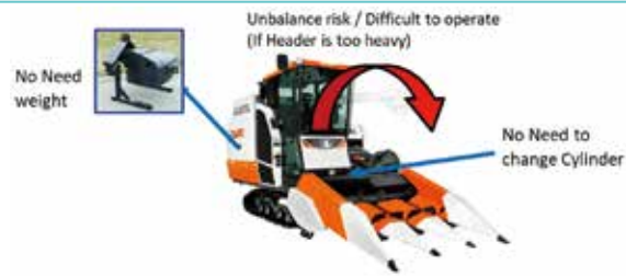
Fig. 4 Counterweight & Hydraulics Cylinder 図 4 カウンターウェイトと油圧シリンダ
