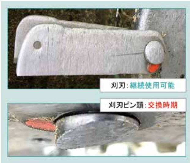
図 10 刈刃と刈刃ピン頭の摩耗
