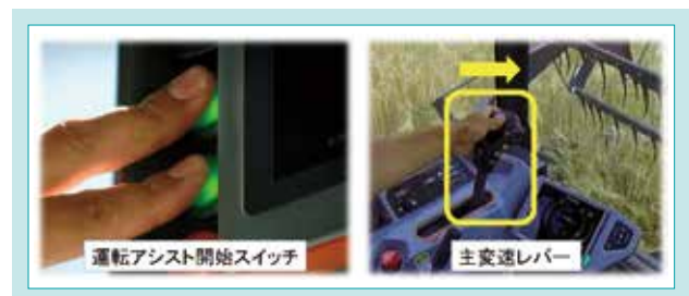
図7 自動運転の開始操作 Fig. 7 Start Operation of Autonomous Driving
