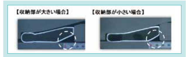
図 11 断面調査によるゴム輪の挙動調査結果 Fig. 11 Result of Section Survey of Rubber Gasket
