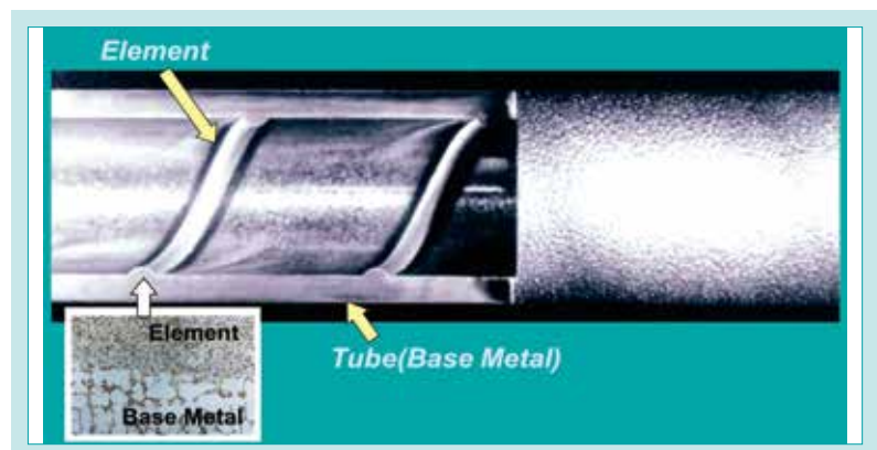
図3 MERTのカットサンプルの外観と組織 Fig. 3 Overview of MERT Cut Sample and the Microstructure
