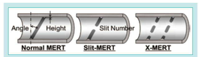
図 9 MERT の攪拌エレメントの配列デザインの多様性
