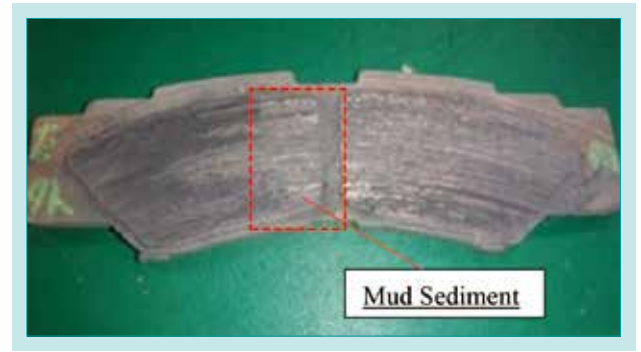
図 11 土砂堆積パッド Fig. 11 Mud Sediment Pad
