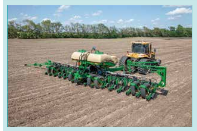
Fig. 2 PL5700 Planter 12 m Wide 図2 PL5700 プランタ 12 m
