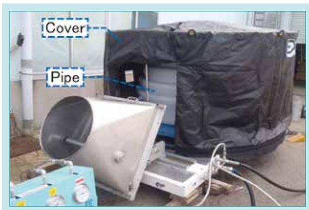
図6 施工性評価加熱装置
