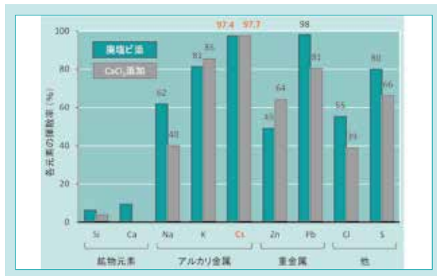
図10 熔融炉での各元素の揮散率
