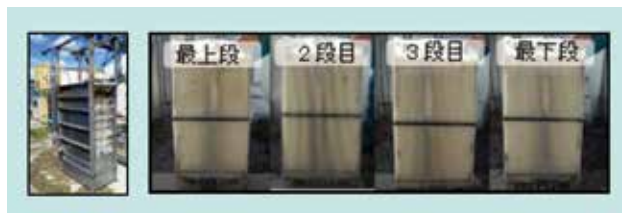
図6 実験装置 SP40と試験終了時の膜モジュール外観 Fig. 6 Experimental Membrane Unit SP 40 and Appearance of the Membrane Module at the End of the Test
