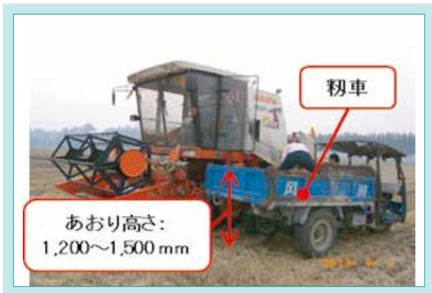
図4 中原地区の一般的な籾車 Fig. 4 Popular Grain Transporting Vehicle In the Target Area
