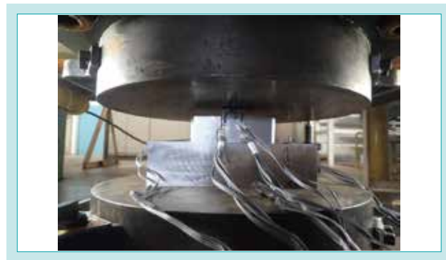
図9 荷重伝達キーの支圧試験
