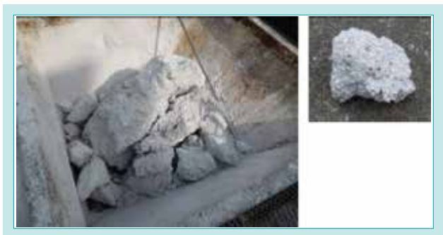
図9 固化した投入物の写真 [CaCl 2 添加条件]
