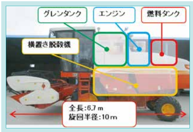
図2 現地他社機の車体レイアウト Fig. 2 Competitor's Machine Layout
