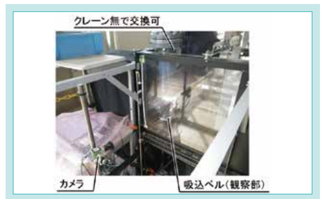
図5 小型模型水槽の実験装置 Fig. 5 Apparatus for Model Testing
