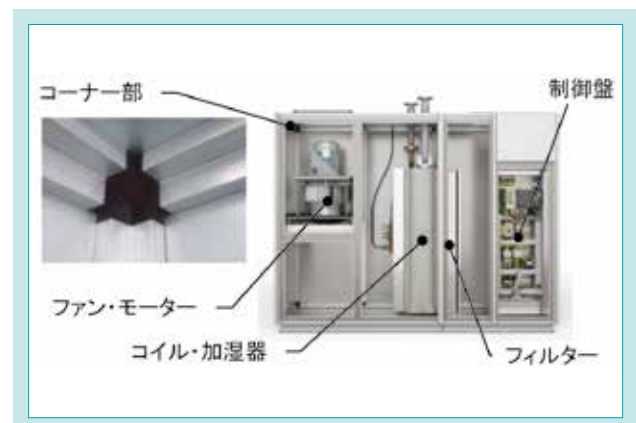
図4 コンパクト型空調機の構造
