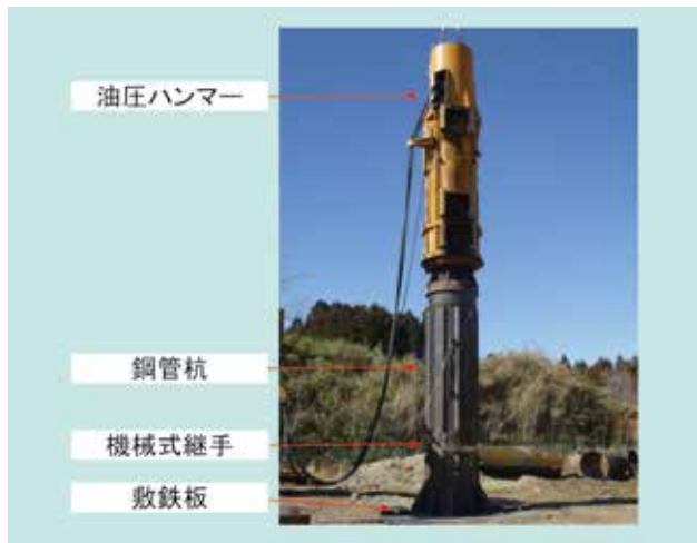
図 12 油圧ハンマーによる繰返し打撃試験
