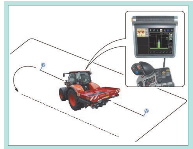
図2 オートステアリング使用方法 Fig. 2 Automatic Steering Method
