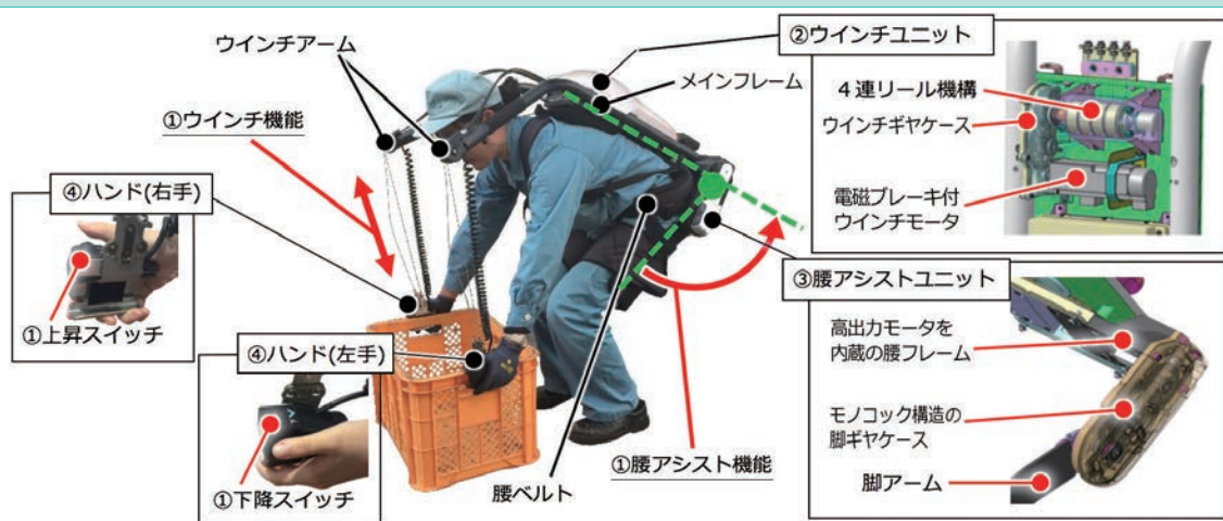
図3 WIN-1 主要機能と関連部位 Fig. 3 WIN-1 Main Functions and Related Parts
