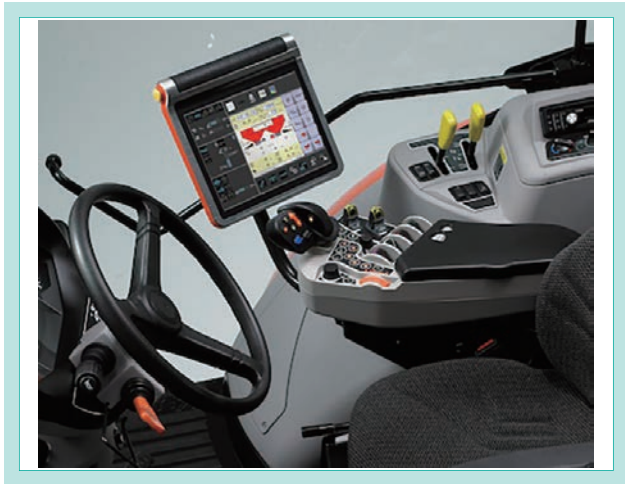
図5 M7トラクタのオールインワンターミナル Fig. 5 All-in-One Terminal of M7 Tractor
