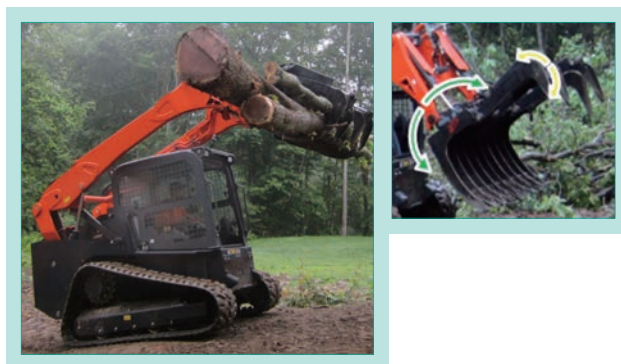
図7 グラップルバケット作業 Fig. 7 Grapple Bucket
