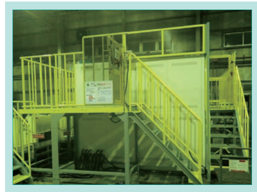
図 3 大型水槽 (長期静水圧試験用) Fig. 3 Hot Bath for Hydrostatic Pressure Test
