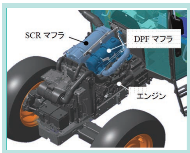
図4 マフラレイアウト概要 Fig. 4 Muffler Layout Overview
