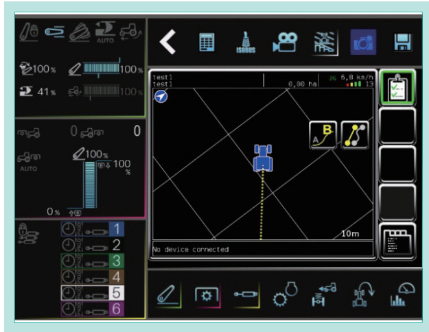
図6 オートステア画面表示 Fig. 6 Display for Automatic Steering
