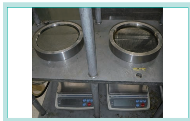
図6 ろ過試験装置
