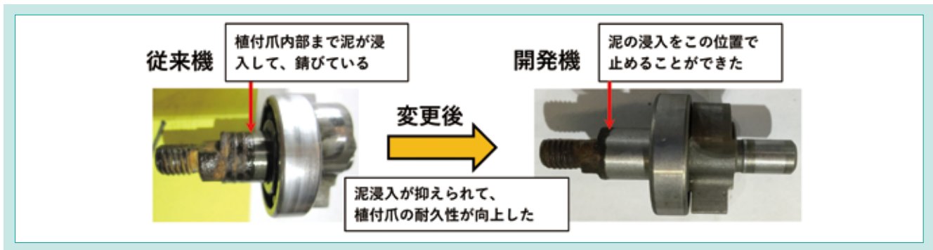
図 11 植付け爪改善結果 Fig. 11 Effect of Planting Claw Improvement
