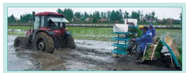
図3 深い水田(深田)にはまった田植機の脱出 Fig. 3 Rice Transplanter Escaping from Deep Paddy
