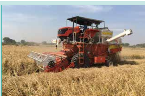
図3 トラクタマウントコンバインでの刈取り作業 Fig. 3 Harvesting with Tractor-mounted Combine
