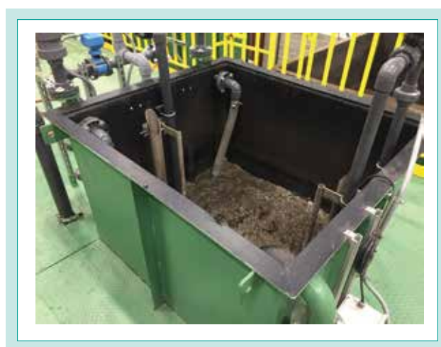
図4 MBRシステム実験設備
