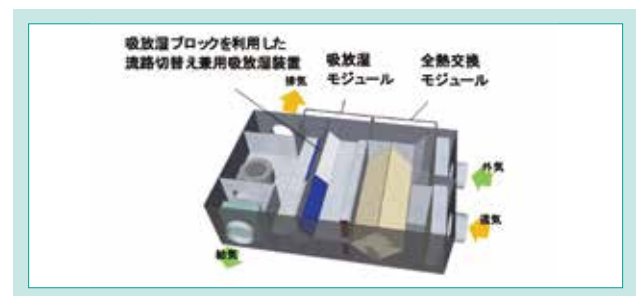
図2 「調湿外気処理ユニット」の構想図
