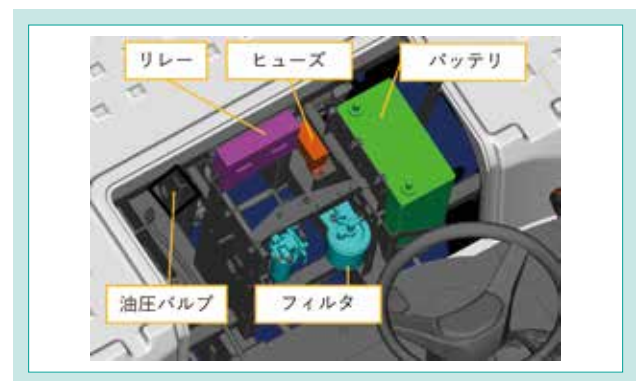
図 12 シート下集中メンテナンス Fig. 12 Central Maintenance Structure Beneath Seat
