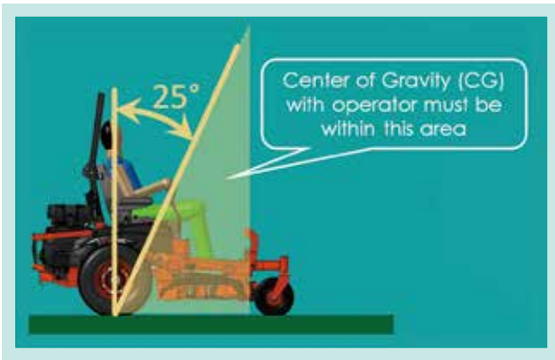
Fig. 3 ZTR Center of Gravity 図3 ゼロターナーモア車体重心位置
