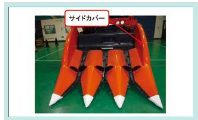
図7 開発機のサイドカバー Fig. 7 Side Cover of a Developed Machine
