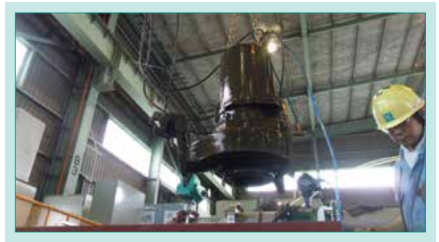
図9 耐久試験後のポンプ取出し
