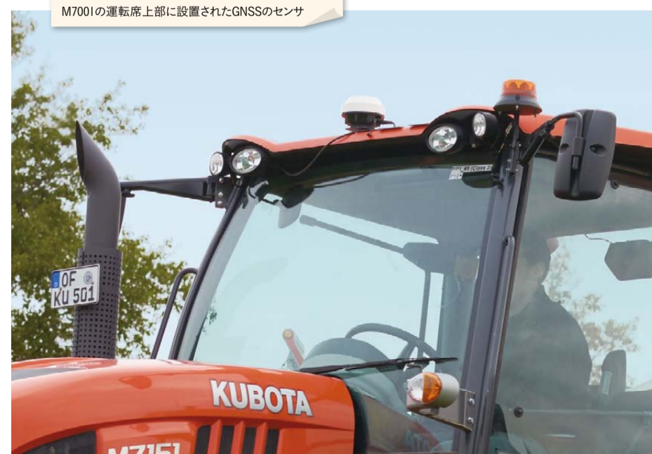
M7001の運転席上部に設置されたGNSSのセンサ
