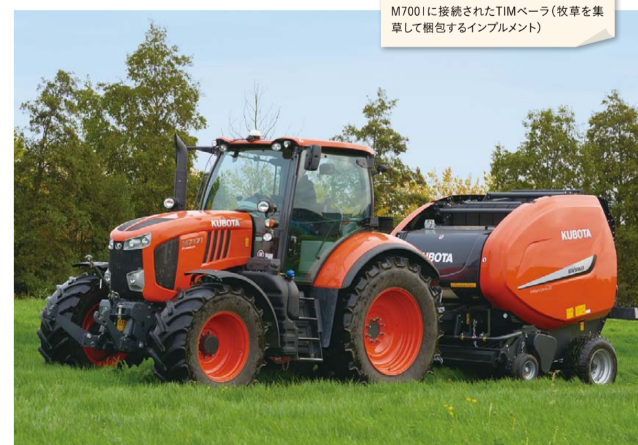
M7001に接続されたTIMベアラ(牧草を収集して梱包するインプラメント)
