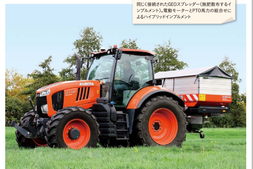
同じく接続されたGEOスプレッダー(施肥散布するインプラメント)。電動モーターとPTO馬力の組合せによるハイブリッドインプラメント
