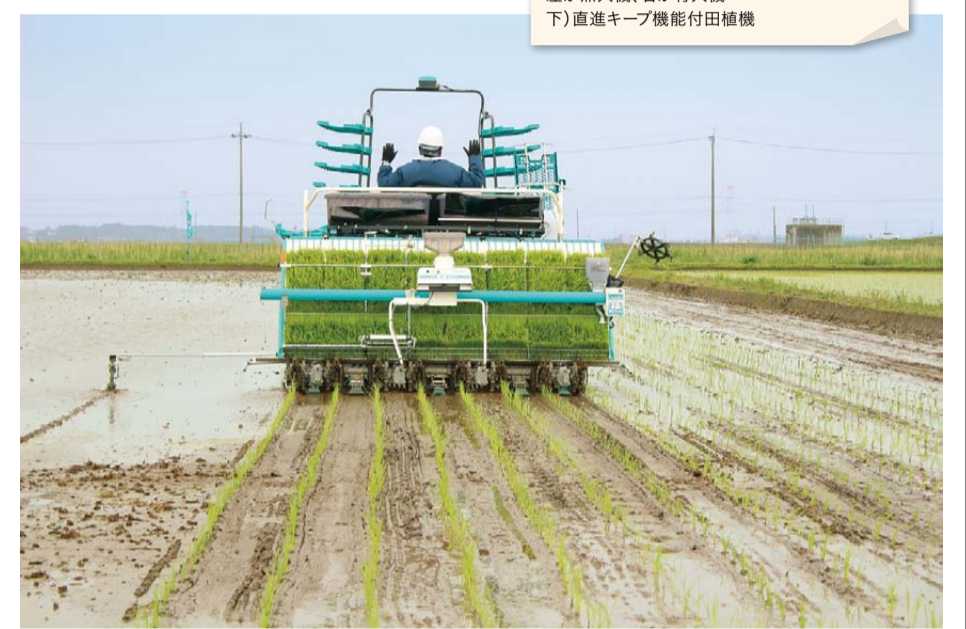
上) オートステアリング機能付自動運転トラクタ。左が無人機、右が有人機 下) 直進キープ機能付田植機
