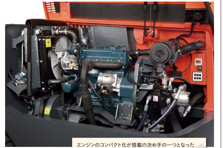
エンジンのコンパクト化が搭載の決め手の一つとなった
